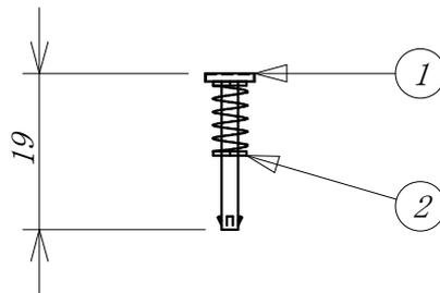
ヒートシンク穴径  $\phi 3.0\text{mm}$
