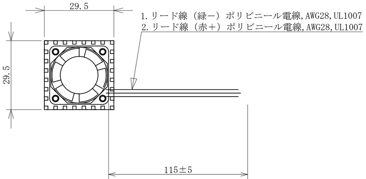
(注) : 本品を扱う際, ファンモーターの羽根部分に圧力が加わる様な取扱いは絶対に避けて下さい。
